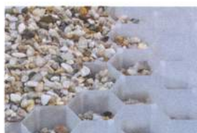
好きなサイズにカットして碎石・砂の転圧後に置くだけの簡単施工
